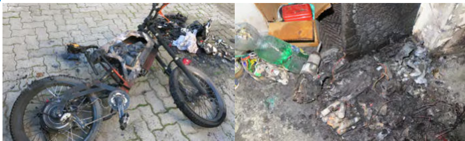
Technická závada baterie elektrokola při jejím nabíjení (vlevo). Zahoření baterie akuvrtačky (vpravo).
